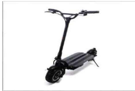
Еще одной разновидностью самоката является электросамокат. Его основное отличие состоит в наличии электродвигателя и аккумуляторной батареи. Крутящий момент передается от электродвигателя к колесам с помощью цепи (как у мотоциклов, мопедов и велосипедов). Также самокат может иметь моторколесо (когда электродвигатель размещается непосредственно в самом колесе).
